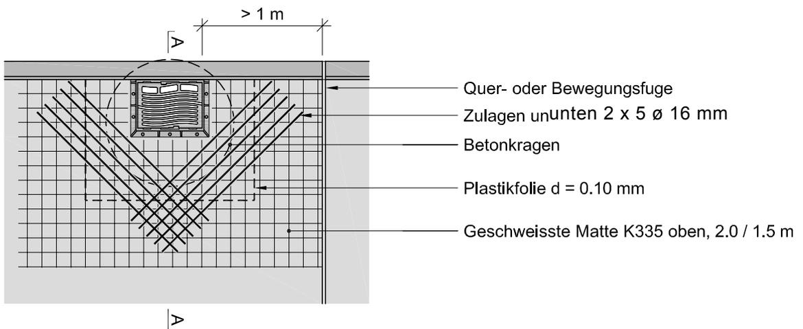
**Grundriss (Anordnung bei Fuge)**
